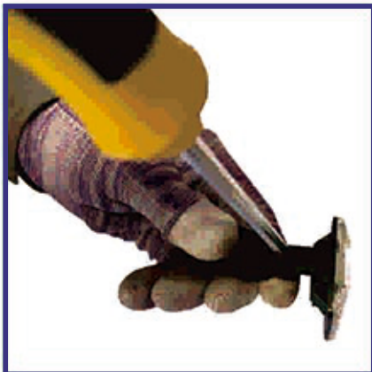
Retire los tornillos del reflector delantero
