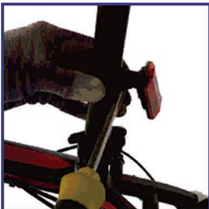
Fije el reflector trasero en el tubo del asiento
