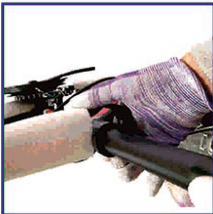
Inserte y cierre el tubo del asiento
